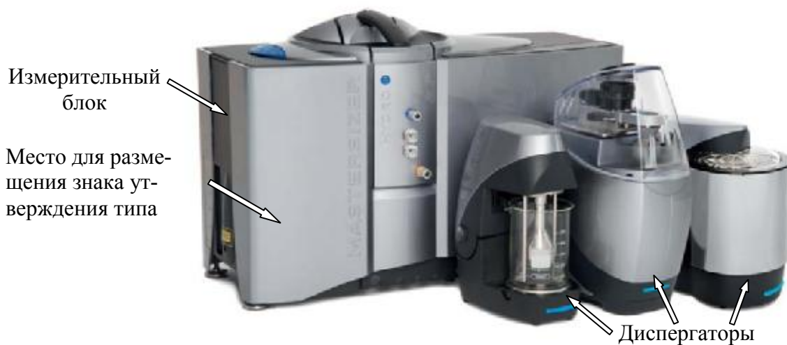
Рисунок 1 – Внешний вид анализаторов и обозначение места для размещения знака утверждения типа
