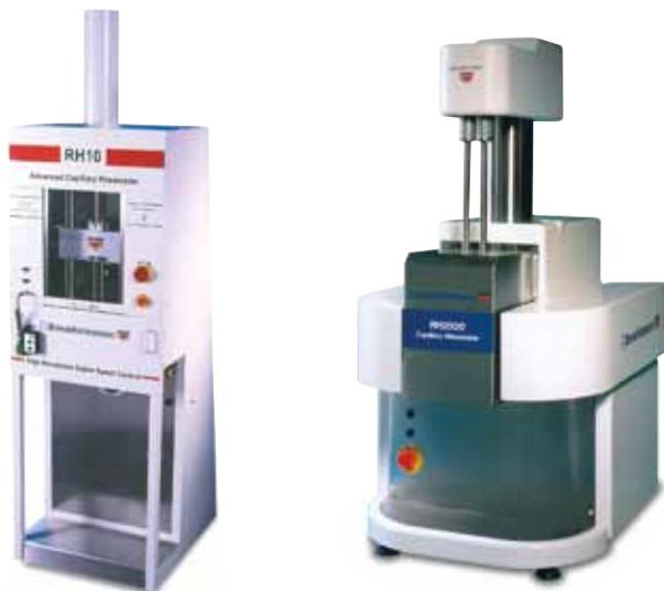
Капиллярные реометры Rosand определяют реологические свойства материалов, непосредственно воссоздавая условия переработки – экструзию при высоких давлениях и скоростях сдвига. Системы позволяют оптимизировать технологические режимы и свойства продукции для достижения максимальной эффективности производства и обеспечения стабильности важнейших функциональных свойств материалов: от расплавов полимеров до керамики; от продуктов питания до красок и различных покрытий.
