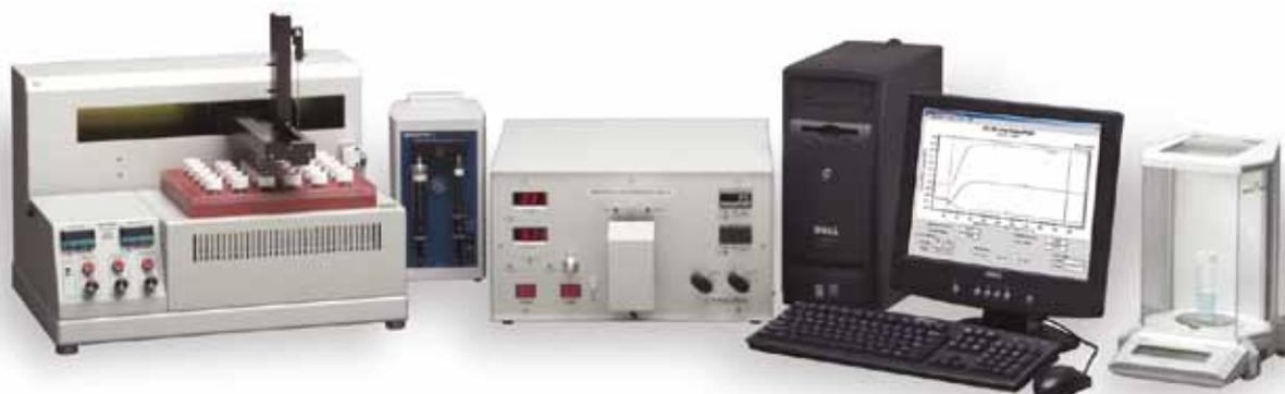
DSV – это полностью автоматизированное комплексное решение для рутинного измерения вязкости растворов полимеров. Значительно более высокая скорость, точность и уровень безопасности анализа по сравнению с традиционным измерением при помощи стеклянного капиллярного вискозиметра.
