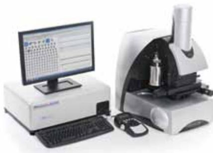
Модель G3-ID расширяет функционал систем Morphologi благодаря возможности химической идентификации отдельных частиц методом рамановской спектроскопии.
